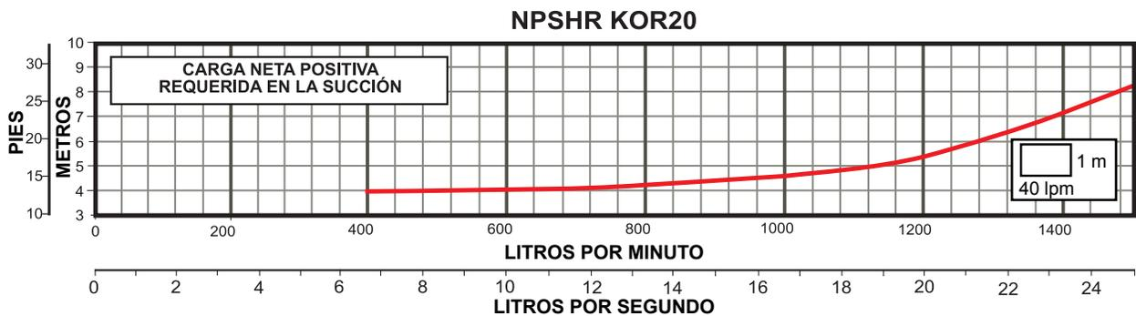
» Trabajar fuera del rango de operación ocasiona alto consumo de energía y daño mecánico en la motobomba.
