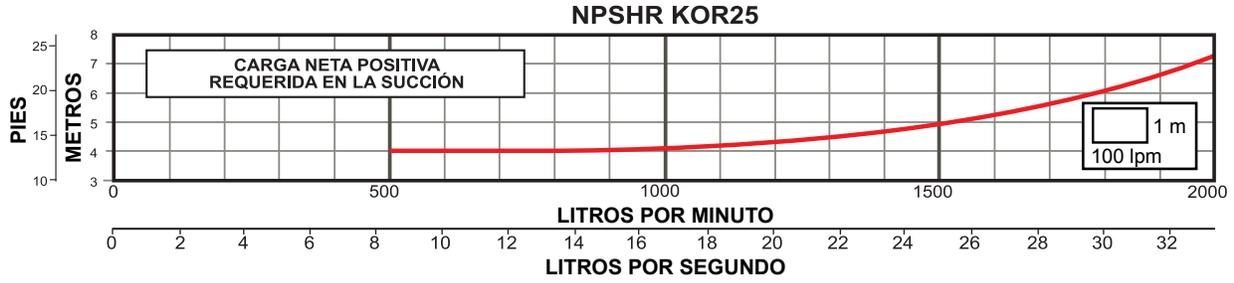
» Trabajar fuera del rango de operación ocasiona alto consumo de energía y daño mecánico en la motobomba.
