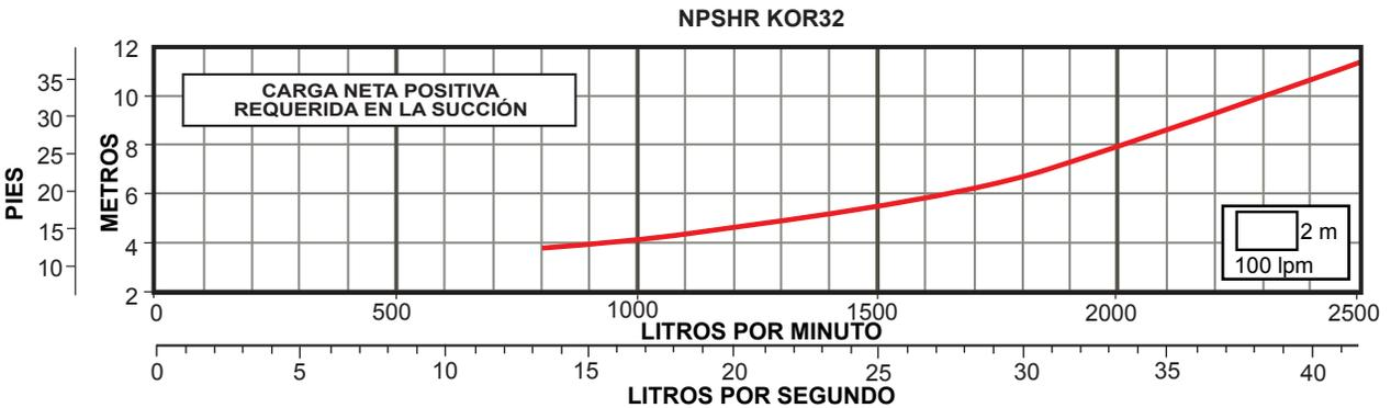
» Trabajar fuera del rango de operación ocasiona alto consumo de energía y daño mecánico en la motobomba.
