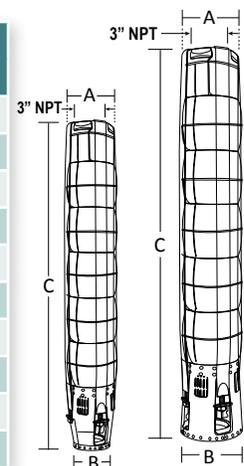
Acoplamiento NEMA 4" Fig. 1      Acoplamiento NEMA 6" Fig. 2
