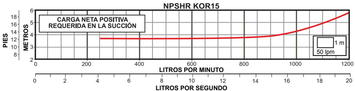
» Trabajar fuera del rango de operación ocasiona alto consumo de energía y daño mecánico en la motobomba.
