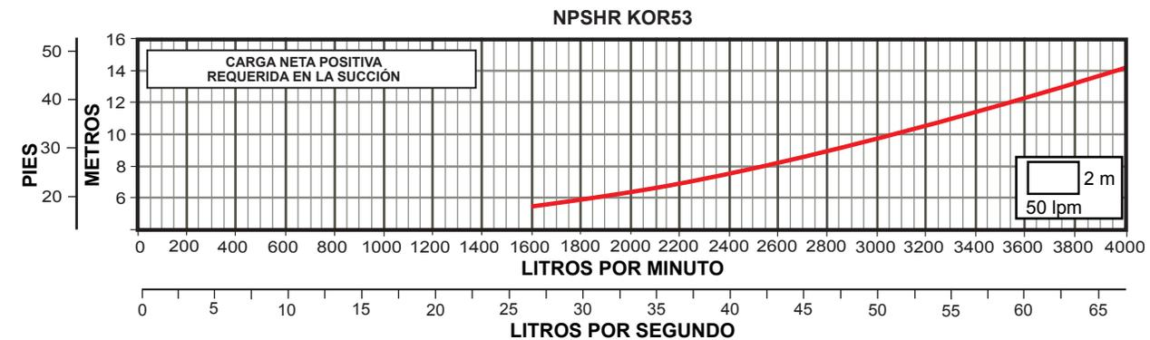
» Trabajar fuera del rango de operación ocasiona alto consumo de energía y daño mecánico en la motobomba.
