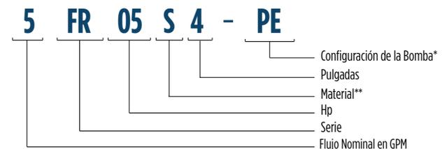
\* Configuración de la bomba: Cambia dependiendo del motor con el que se seleccione la bomba.
