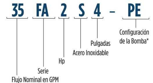
\* Configuración de la bomba: Cambia dependiendo del motor con el que se seleccione la bomba.
