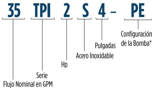
\* Configuración de la bomba: Cambia dependiendo del motor con el que se seleccione la bomba.
