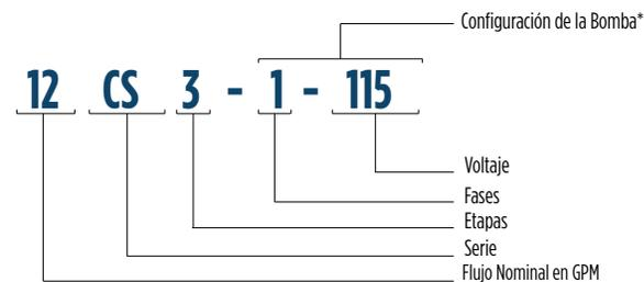
\* Configuración de la bomba: Cambia dependiendo de las fases y el voltaje del motor con el que se seleccione la bomba.
