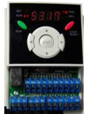
El comando de cuatro direcciones en la pantalla hace de la configuración algo realmente sencillo y rápido.
