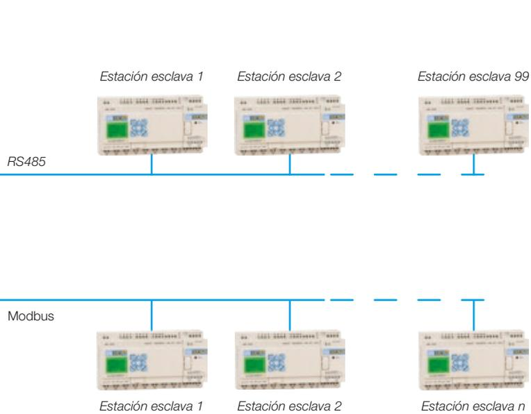
Nota: las funciones arriba citadas están disponibles solamente para los modelos 20VT-D y 20VR-D o utilizando el módulo de comunicación CLW02 MBUS 3RD.
