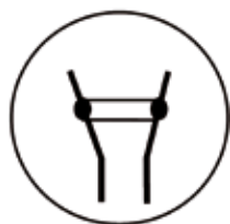
IEC/EN 60947-5-1 Contactos enclavados mecánicamente
